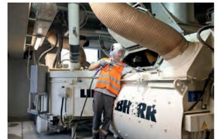
Reinigung des Mixers im Betonwerk | SCHWENK
