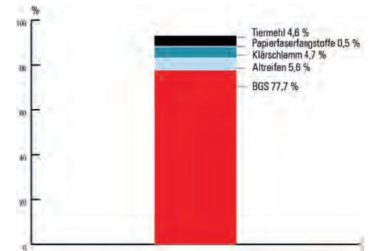
Alternativer Brennstoffmix bei der Klinkerproduktion bezogen auf den Mengeneinsatz 2023 in Tonnen
