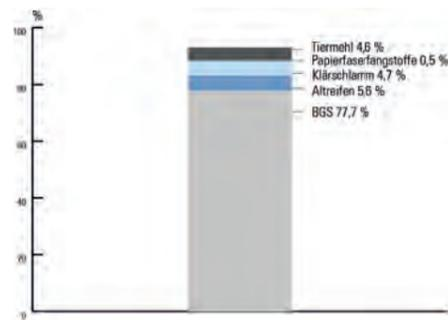
Alternativer Brennstoffmix bei der Klinkerproduktion bezogen auf den Brennstoffmengenverbrauch 2023 in Tonnen
