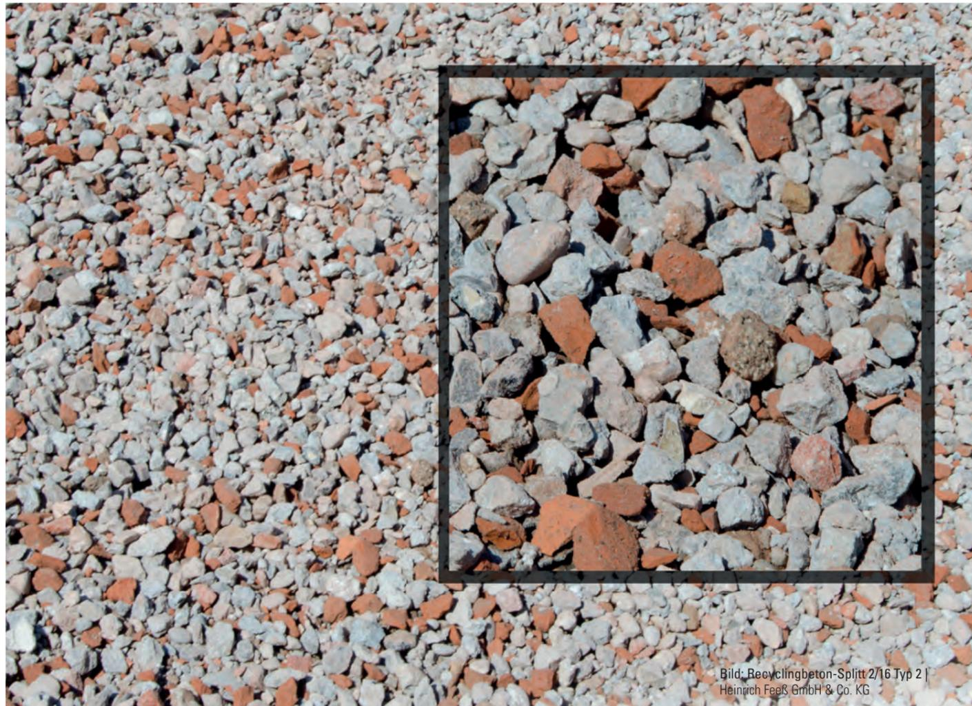
Bild: Recyclingbeton-Splitt 2/16 Typ 2 |
