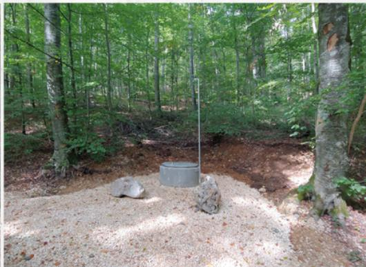
Grundwassermessstelle mit dauerhafter Aufzeichnung und Fernüberwachung
