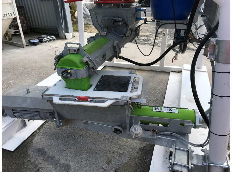
Silomischpumpe »Hicomp«: Nassmischzone und Vorratsbehälter mit Schneckenpumpe
