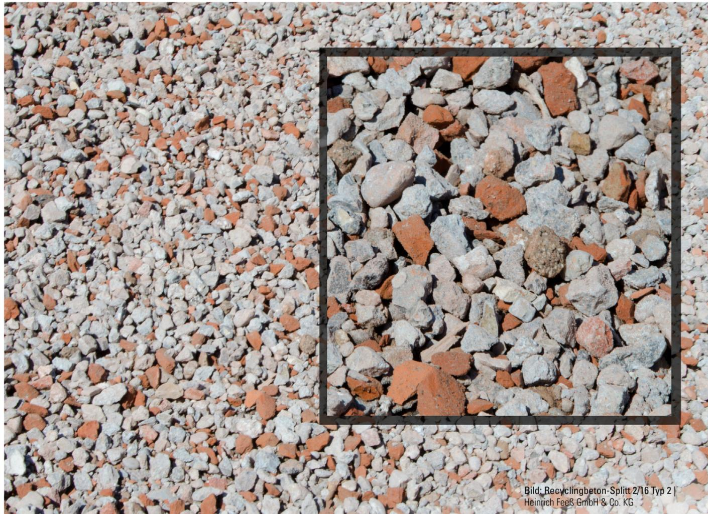
Bild: Recyclingbeton-Splitt 2/16 Typ 2 |
