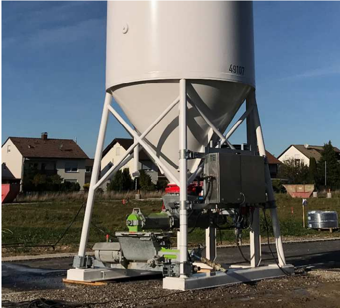
Anmischen lose Ware mit Silomischpumpe Hicomp
