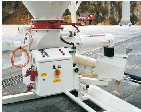
Anmischen lose Ware mit Silomischpumpe »quadro-mat«
