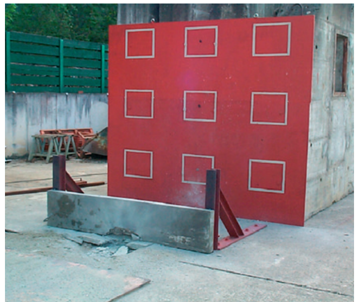
Bild 6 und 7: Einsatz von Duracrete® basic im Bereich des Gebäudeschutzes, Explosions-simulation oben – normaler Stahlbeton, unten – Ducon®-Wand mit Duracrete® basic (Quelle: Ducon GmbH, www.ducon.de )
