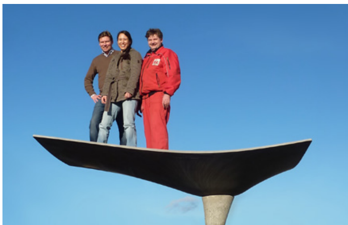
Bild 11: DUCON definiert die Materialeigenschaften von Beton neu: Dünn, duktil und tragfähig
