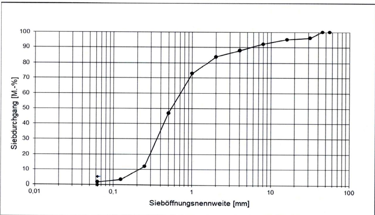
**Abbildung 1:** Korngrößenverteilung Rohkiessand – Probe Nr. 21-364
