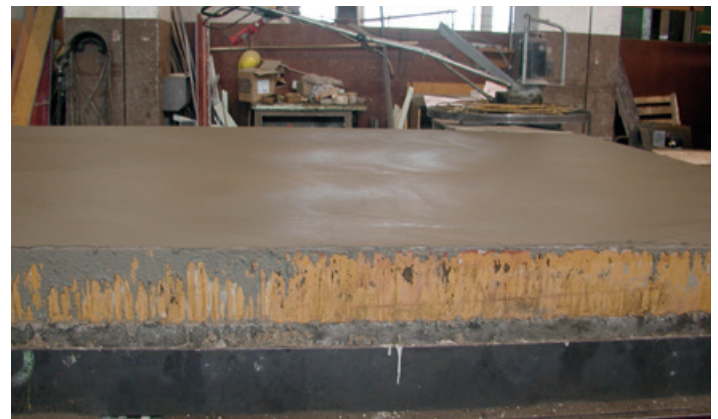
Bild 4: Nach 1,5 Stunden flügelgeglättete Betonoberfläche mit Fastcrete® plus
