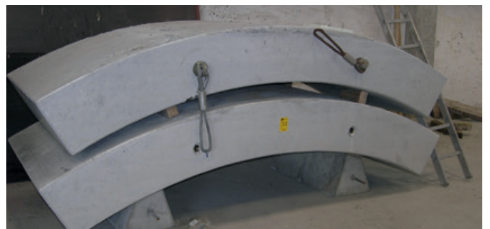
Bild 10: Tübbinge – Rationeller Fertigungsablauf bei tiefen Temperaturen
