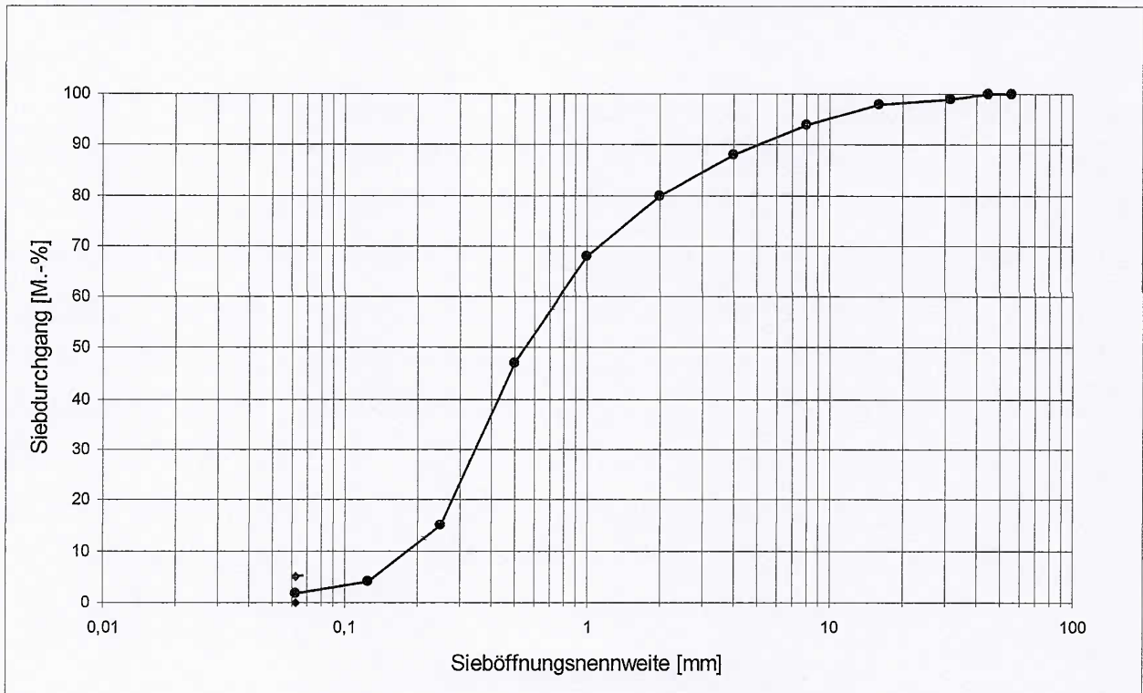
Abbildung 1: Korngrößenverteilung Rohkiessand – Probe Nr. 19-387
