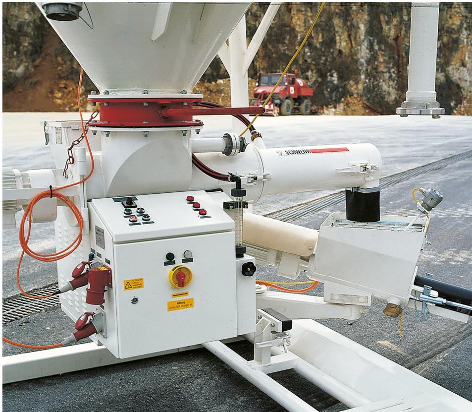
Silomischpumpe »quadro-mat«: Trocken und Nassmischzone mit Bedienpult
