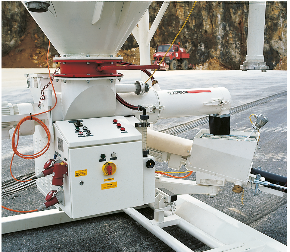
Silomischpumpe »quadro-mat«: Trocken und Nassmischzone mit Bedienpult
