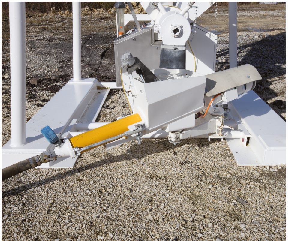
Silomischpumpe »quadro-mat«: Vorratsbehälter mit Schneckenpumpe
