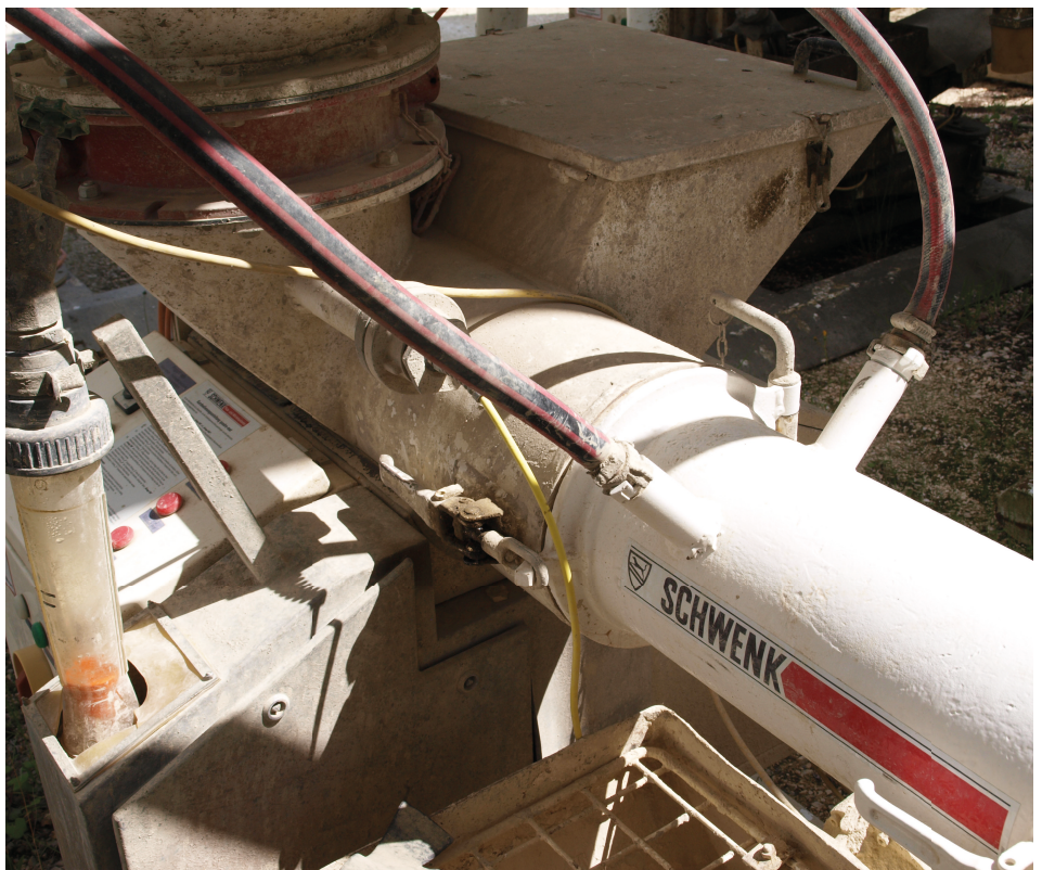
Silomischpumpe Füllbinder® »quadro-mat« mit großem Schauglas und doppelter Wasserzuführung für größere Wasserzugabemengen. Die Wasserdosierung ist über ein Handrad, angeordnet oberhalb des Schauglases, möglich.
