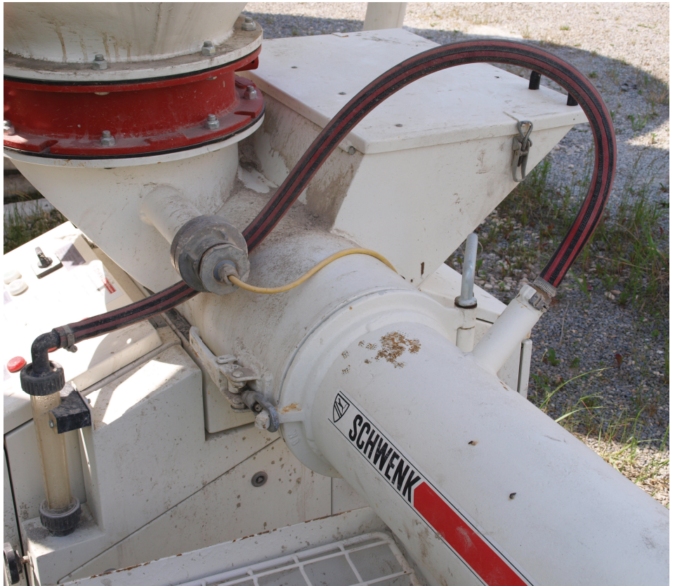
Silomischpumpe »quadro-mat« mit kleinem Schauglas und einfacher Wasserzuführung für geringere Wasserzugabemengen. Die Wasserdosierung ist über ein Handrad, angeordnet unterhalb des Schauglases, möglich.
