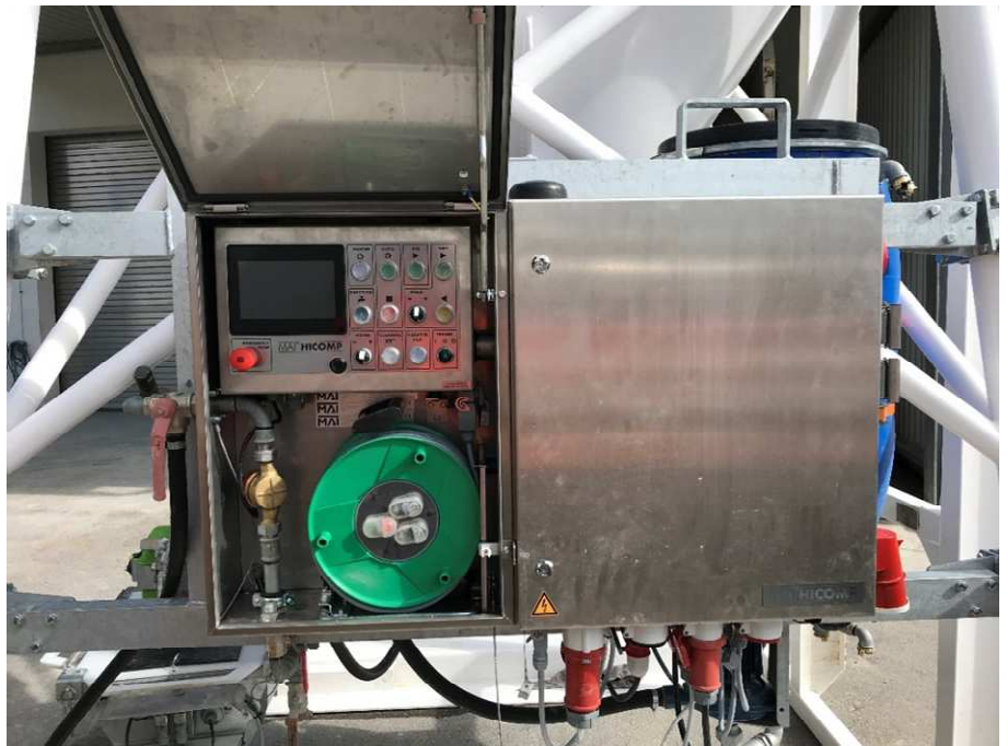
Silomischpumpe »Hicomp«: Bedien- und Steuereinheit mit Fernbedienung über Kabeltrommel
