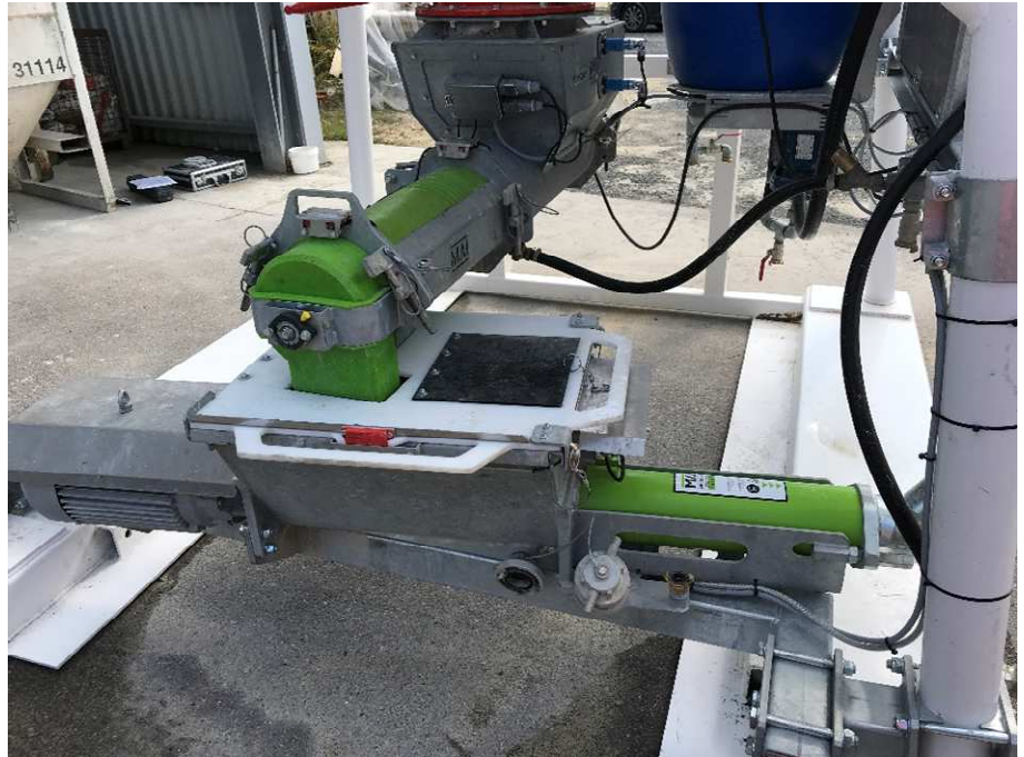
Silomischpumpe »Hicomp«: Nassmischzone und Vorratsbehälter mit Schneckenpumpe
