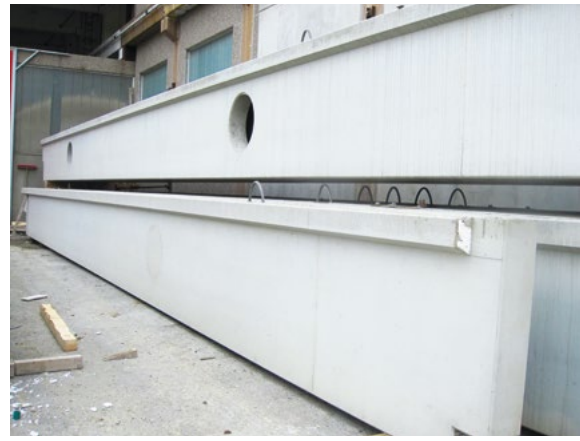
Fertigteile, betoniert mit Fastcrete® plus
