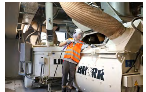
Reinigung des Mixers im Betonwerk | SCHWENK
