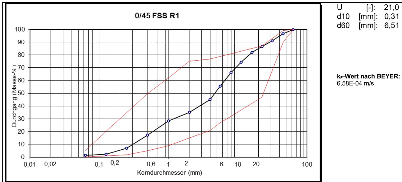
Das untersuchte Baustoffgemisch entspricht hinsichtlich der Korngrößenverteilung den Anforderungen gemäß TL SoB-StB an ein Baustoffgemisch für Frostschutzschichten.
