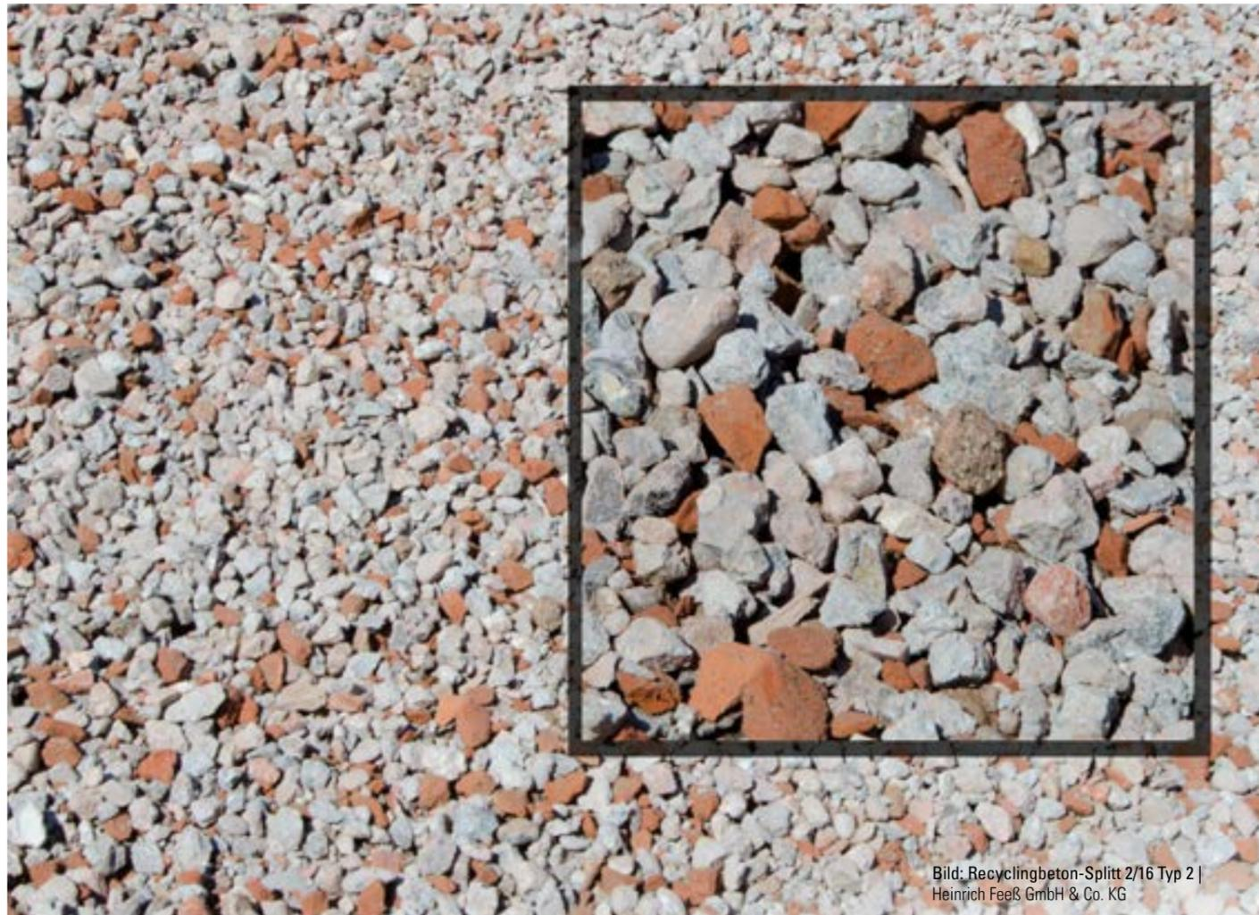
Bild: Recyclingbeton-Splitt 2/16 Typ 2 |
