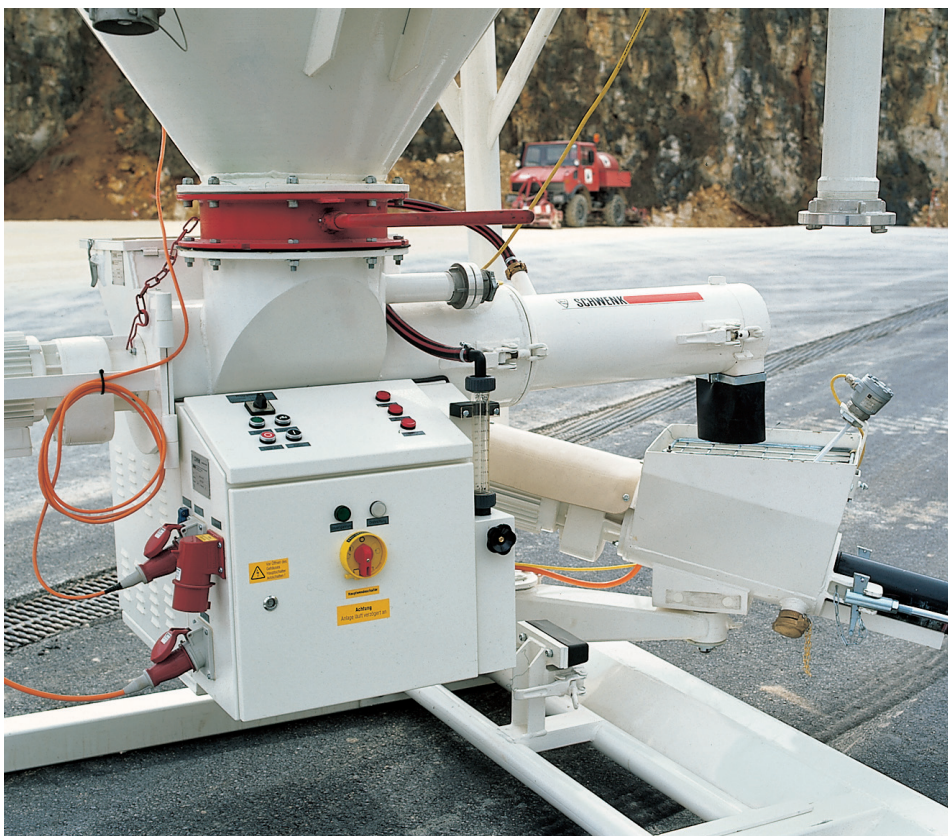
Silomischpumpe »quadro-mat«: Trocken und Nassmischzone mit Bedienpult
