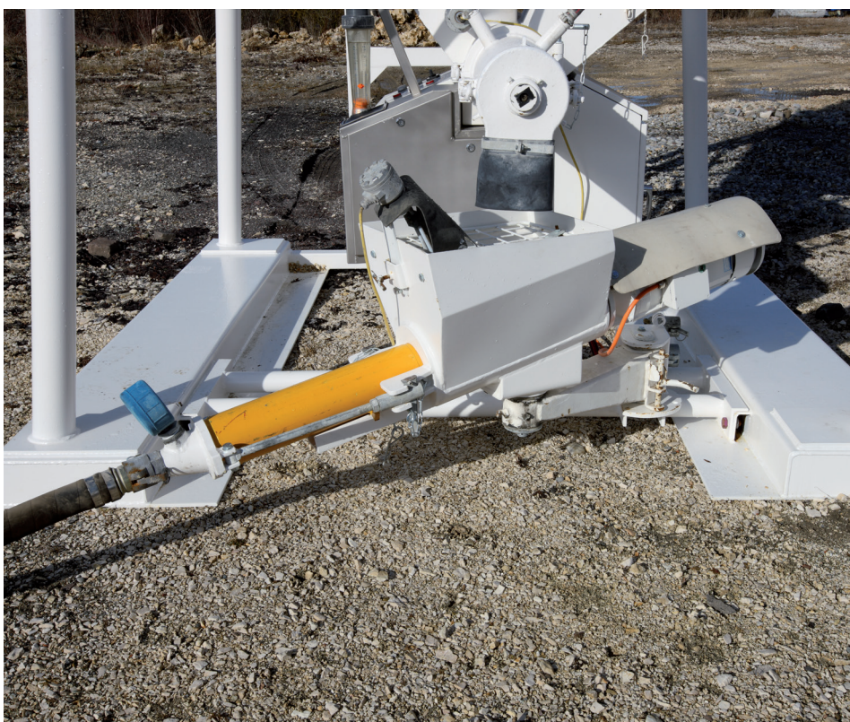
Silomischpumpe »quadro-mat«:Vorratsbehälter mit Schneckenpumpe
