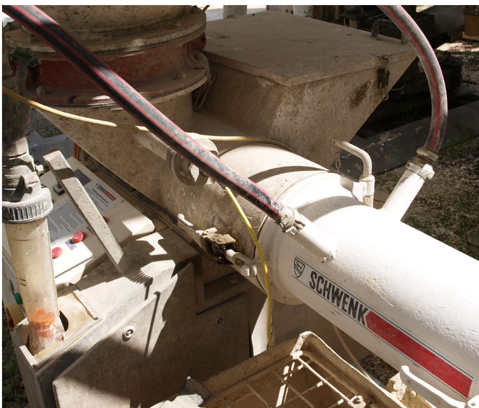
Silomischpumpe Füllbinder® »quadro-mat« mit großem Schauglas und doppelter Wasserzuführung für größere Wasserzugabemengen. Die Wasserdosierung ist über ein Handrad, angeordnet oberhalb des Schauglases, möglich.
