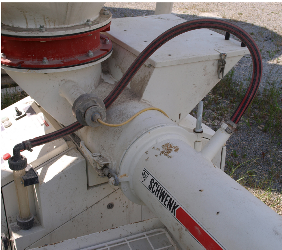
Silomischpumpe »quadro-mat« mit kleinem Schauglas und einfacher Wasserzuführung für geringere Wasserzugabemengen. Die Wasserdosierung ist über ein Handrad, angeordnet unterhalb des Schauglases, möglich.
