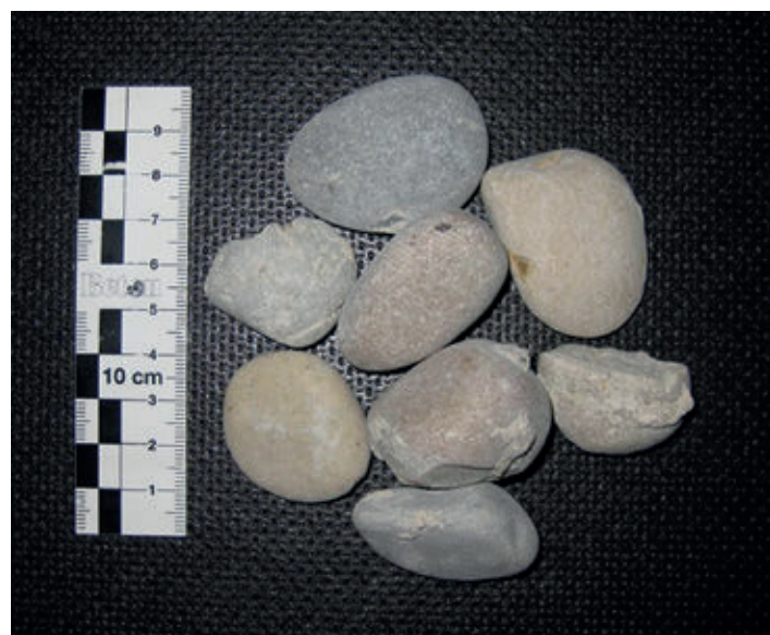
Bild 3: Rezyklierter Gesteinskörnung aus erhärtetem Beton; hergestellt durch elektrodynamisches Pulsen
