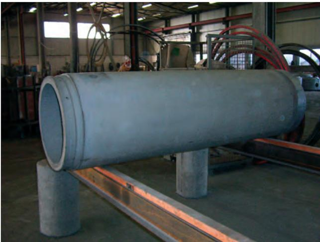
Bild 5: Einsatz von *Duracrete® basic* im Rohrbereich (Ducon® - Rohr DN 400)
