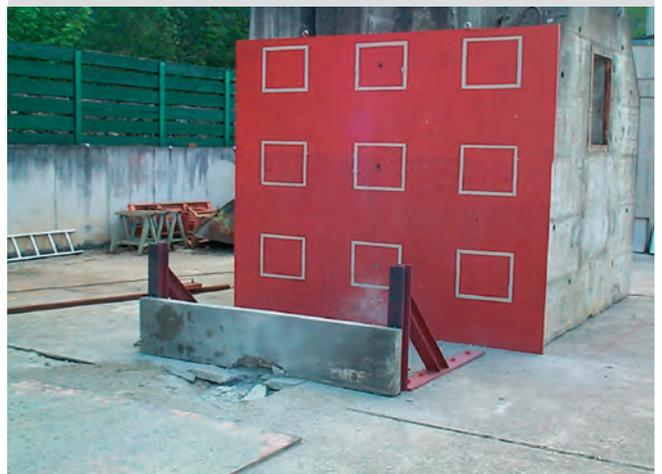
Bild 6 und 7: Einsatz von *Duracrete® basic* im Bereich des Gebäudeschutzes, Explosions-simulation oben – normaler Stahlbeton, unten – Ducon®-Wand mit *Duracrete® basic* (Quelle: Ducon GmbH, [www.ducon.de](http://www.ducon.de))
