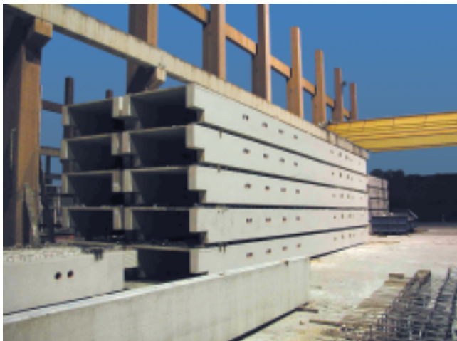
Bild 8: Spannbetonelemente – Verkürzte Umspannzeiten bei Spannbeton
