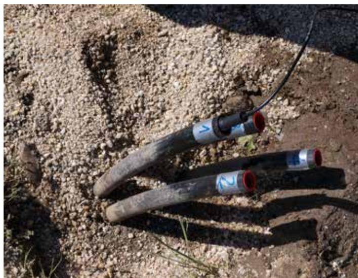
Befahren der Sondenrohre zur Messung der Bohrlochverfüllung
